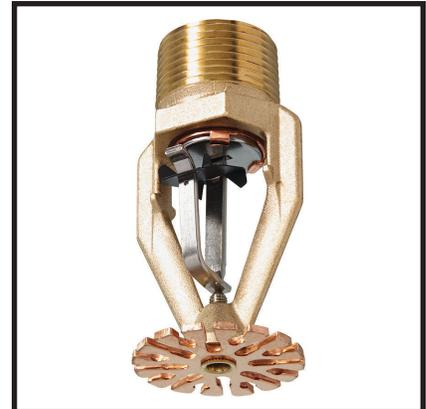
Los rociadores modelo ESFR-25 están homologados por Underwriters Laboratories (UL) para aplicaciones específicas con una altura de almacenamiento máxima de 43 ft (13,1 m) con una altura de cielorraso máxima de 48 ft (14,6 m) sin el requisito de rociadores en anaqueles. Consulte la homologación (UL) para la aplicación específica para ver los criterios de diseño.
