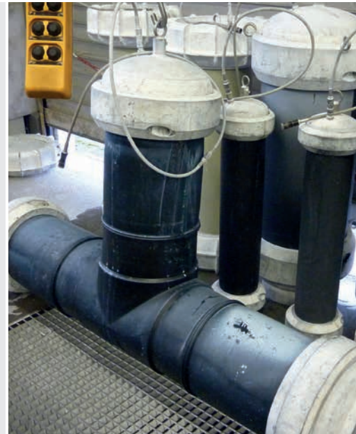
SIMONA® PE 100 FM-Line test specimens
