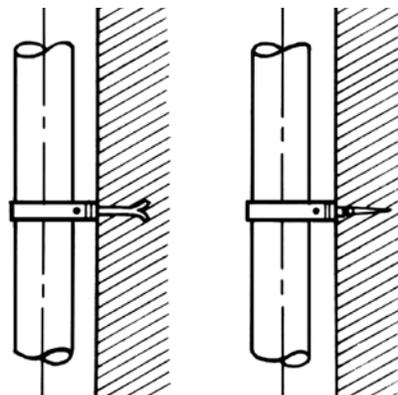
Los soportes de la tubería deben colocarse cada 3 metros en los tramos verticales y cada 2 metros en los tramos horizontales.
