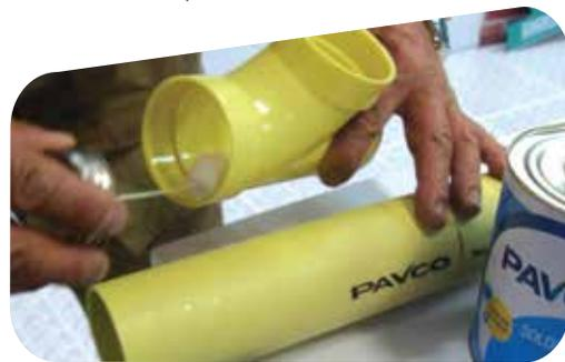
6. Una el tubo con el accesorio asegurándose de un buen asentamiento y déle un cuarto de vuelta para distribuir la soldadura, mantenga firmemente la unión por 30 segundos.
