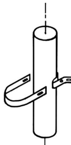
Tanto la abrazadera fija como la corrediza pueden asegurarse a los techos o paredes por medio de tornillos de acero o empotrarse por medio de un gancho de platina metálica.
